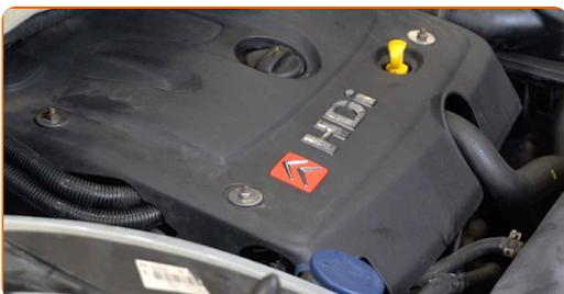
**24** Preverite nivo olja 5 minut po prenehanju delovanja motorja tako da uporabite merilno palico in po potrebi dodate olje.
