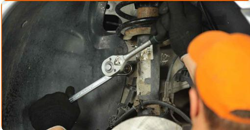
8 Odvijte pritrdilni element, ki povezuje jarmov drog na palico stabilizatorja. Uporabite kombinirani ključ №18. Uporabite imbus št. H6. Uporabite izvijač z zatikalom.
