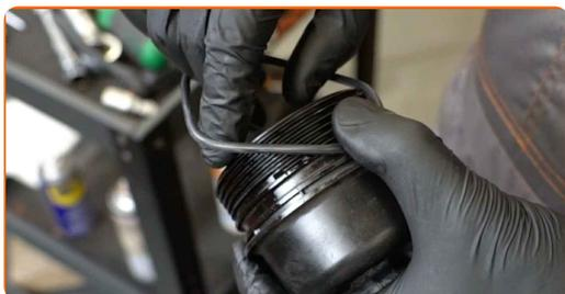
**17** Namestite nov oljni filter na sedež za namestitev na pokrovu filtra.
