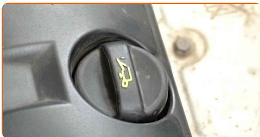
**30** Pustite da motor nekaj minut deluje. Ko ugasne opozorilna lučka za pritisk olja, ugasnite motor.
