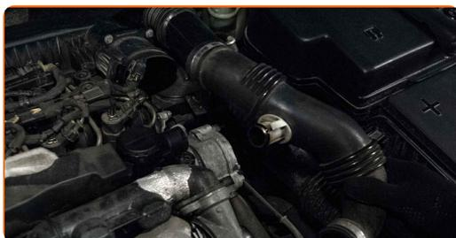
**18** Vključite konektor senzorja za masovni pretok zraka.
