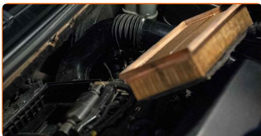
**12** Očistite pokrov zračnega filtra in ohišje.
