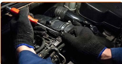
9 Odstranite pritrdilne vijake pokrova zračnega filtra. Uporabite Phillips križni izvijač.
