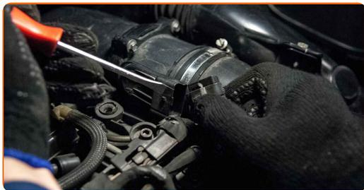
**19** Pritrdite vpenjalni kos na cev za dovod zraka. Uporabite ploščat izvijač.
