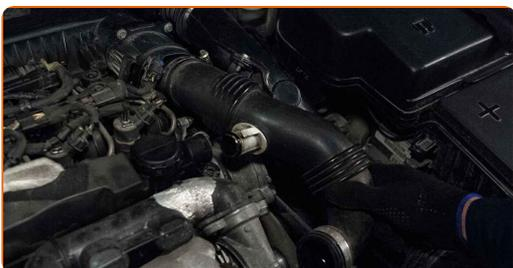
7 Pokrijte ventilator turbo polnilnika s krpo iz mikrovlaknen, da preprečite vdor umazanije in tujih delcev v sistem.
