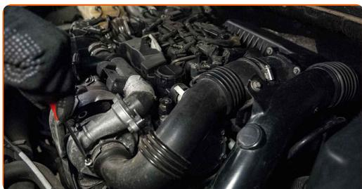
**20** Privijte pritrdilno objemko, ki povezuje zračni kanal z ohišjem zračnega filtra. Uporabite ploščat izvijač.
