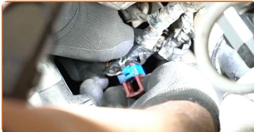
**4** Očistite pritrdilni element lambda sonde. Uporabite žično krtačo. Uporabite sprej WD-40.
