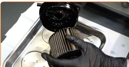
**15** Očistite ohišje in pokrov filtra za gorivo. Uporabite večnamenski čistilni sprej.
