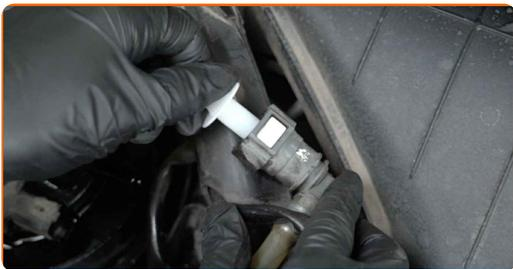
**8** Odvijte pritrdilne elemente pokrova ohišja filtra za gorivo. Uporabite nasadni ključ №27. Uporabite izvijač z zatikalom.
