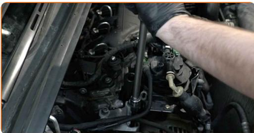
**20** Odstranite podporo izpod motorja.
