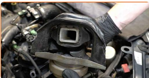
Menjava: nosilca motorja – CITROËN C5 II (RC\_). AUTODOC priporoča:
