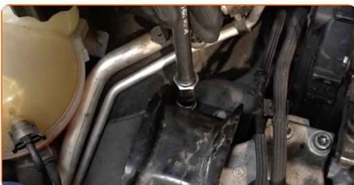
9 Odvijte pritrdilne elemente vležajenja motorja. Uporabite vijačni nastavek T50. Uporabite izvijač z zatikalom.
