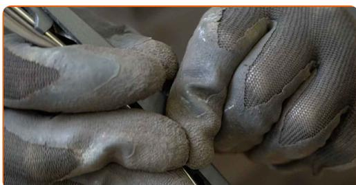
**4** Odstranite metlico iz ročice brisalnika.
