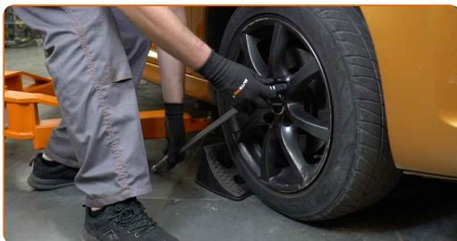
**4** Vzdignite sprednji del avtomobila in otrdite podporne.
