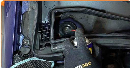
6 Sprostite zgornji pritrdilni element sedeža za namestitev blažilnika. Uporabite nasadni ključ №21. Uporabite imbus št. H7. Uporabite izvijač z zatikalom.
