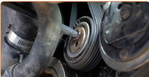
13 Odmaknite napenjalni valj rebrastega jermena. Uporabite podaljšek s kvadratnim pogonom 1/4". Uporabite izvijač z zatikalom.
