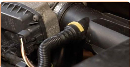
**19** Pritrdite vpenjalni kos na cev za dovod zraka. Uporabite nasadni ključ №7. Uporabite izvijač z zatikalom.
