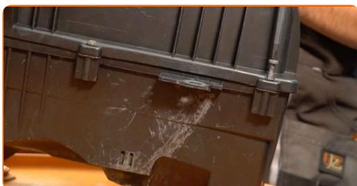
**15** Odstranite krpo iz mikrovlaknen iz cevi za dovod zraka.
