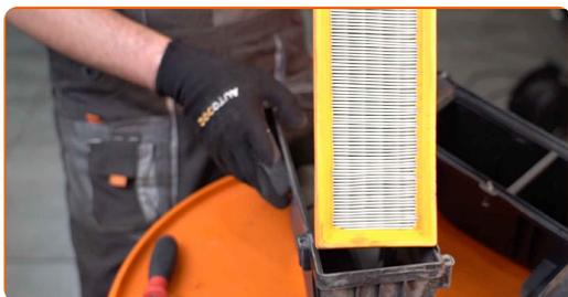
11 Očistite pokrov zračnega filtra in ohišje.
