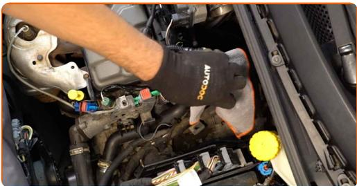
**16** Ponovno namestite ohišje zračnega filtra.
