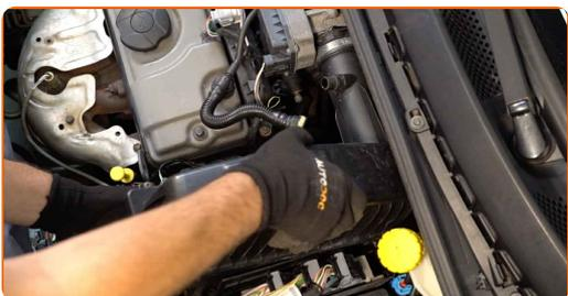
**17** Privijte pritrdilne vijake ohišja filtra. Uporabite nasadni ključ №10. Uporabite izvijač z zatikalom.
