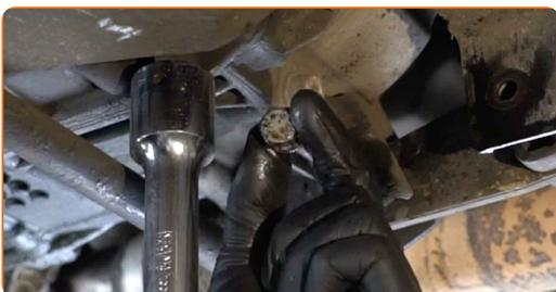
**10** Odstranite vležajenje motorja.
