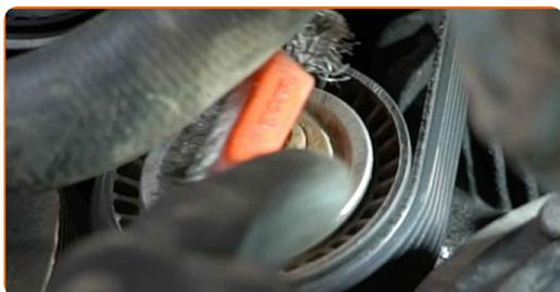
**12** Sprostite pritrdilni element napenjalne jermenice. Uporabite imbus št. H8. Uporabite izvijač z zatikalom.
