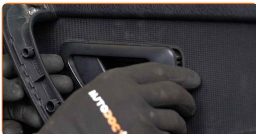
31 Privijte spodnje pritrdilne elemente vratnega panela. Uporabite vijačni nastavek T20.
