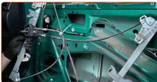
19 Namestite novi mehanizem regulatorja okna.
