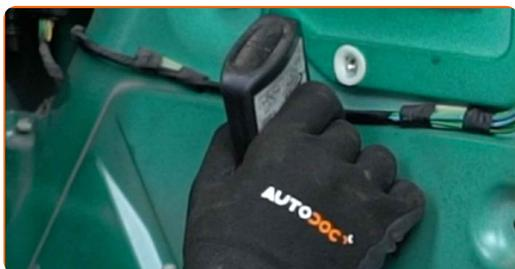
21 Zategnite pritrdilne elemente sklopa regulatorja okna. Uporabite nasadni ključ №10. Uporabite navorni ključ. Zategnite ga do navora 12 Nm.
