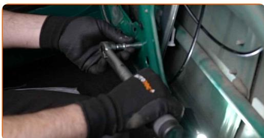
22 Spustite okensko steklo in ga namestite na njegov vgradni prostor v mehanizem regulatorja za okno.
