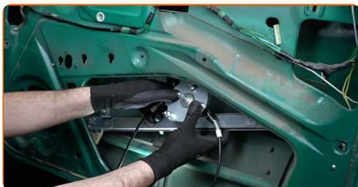
20 Obdelajte navoj pritrdilnih elementov regulatorja okna. Uporabite lepilo za tesnenje vijakov.
