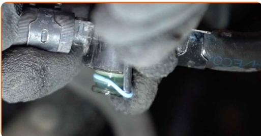
**13** Namestite novi o-obroč. Uporabite ploščat izvijač.
