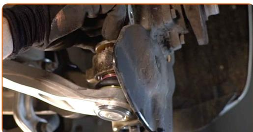
**19** Odklopite zglob od volanskega členek. Uporabite snemalec nosilnega zgiba.
