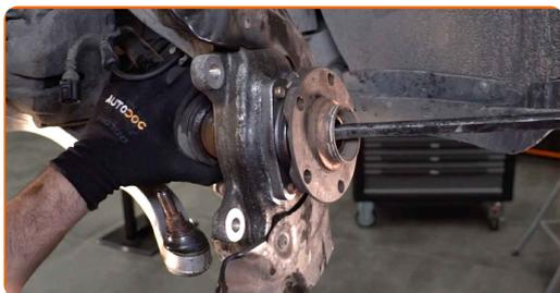
**44** Obdelajte vse dele prečnega vodila. Uporabite bakreno mast.
