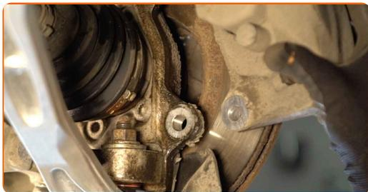
**13** Odklopite pritrdilni element kabla ABS senzorja. Uporabite lomilko.
