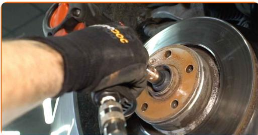
**62** Obdelajte pritrdilni element, ki povezuje glavo jarmovega droga s premnikom. Obdelajte vse dele prečnega vodila. Uporabite bakreno mast.
