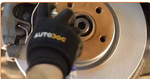
**64** Očistite površino zavornih kolutov. Uporabite čistilo zavor.
