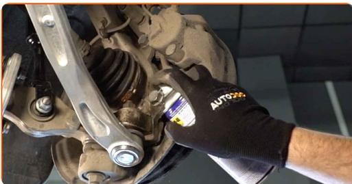
**11** Odvijte pritrditve nosilec čeljusti. Uporabite nasadni ključ №21. Uporabite izvijač z zatikalom. Uporabite udarni nasadni ključ.
