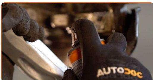
**45** Očistite sedež za namestitev nosilnega zgiba. Uporabite žično krtačo. Uporabite sprej WD-40.
