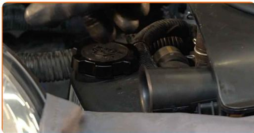
**24** Pustite da motor nekaj minut deluje. Ko ugasne opozorilna lučka za pritisk olja, ugasnite motor.
