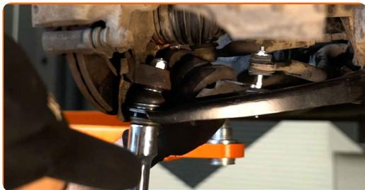
**13** Zategnite pritrdilni element, ki povezuje drog stabilizatorja z vilicami. Uporabite kombinirani ključ №10. Uporabite kombinirani ključ №13. Uporabite nasadni ključ №13. Uporabite navorni ključ. Zategnite ga do navora 18 Nm.
