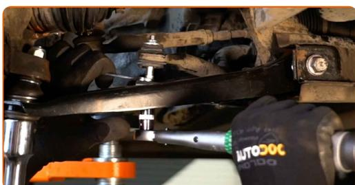
**14** Zategnite pritrdilni element, ki povezuje jarmov drog na palico stabilizatorja. Uporabite kombinirani ključ №10. Uporabite nasadni ključ №13. Uporabite navorni ključ. Zategnite ga do navora 18 Nm.
