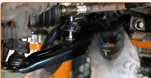
**12** Podprite ročico. Uporabite dvigalko s hidravličnim prenosom.
