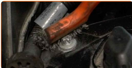
**4** Sprostite zgornje pritrdilne elemente vzmetne noge. Uporabite vijačni nastavek E12. Uporabite izvijač z zatikalom.
