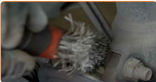
**15** Odvijte pritrdilne elemente, ki povezujejo vzmetno nogo s premnikom. Uporabite nasadni ključ N°21. Uporabite vijačni nastavek E14. Uporabite vijačni nastavek E18. Uporabite izvijač z zatikalom.
