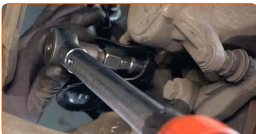
**45** Pritrdite spodnje pritrdilne elemente, ki povezujejo blažilnik in premnik. Uporabite vijačni nastavek E14. Uporabite navorni ključ. Zategnite ga do navora 100 Nm.
