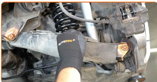
**37** Privijte pritrdilne elemente plastičnega pokrova upravljalnega vzvoda. Uporabite nasadni ključ N°10. Uporabite izvijač z zatikalom.
