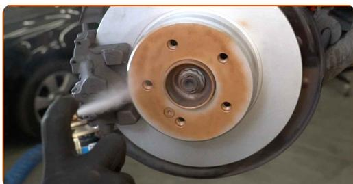
**39** Očistite površino zavornih kolutov. Uporabite čistilo zavor.
