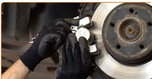
**23** Zategnite pritrdilne elemente zavorne čeljusti. Uporabite nasadni ključ №16. Uporabite navorni ključ. Zategnite ga do navora 55 Nm.
