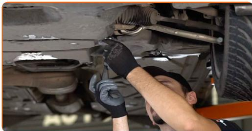
**23** Zategnite pritrdilne elemente na spodnjem pokrovu oljnega korita. Uporabite nasadni ključ №8. Uporabite izvijač z zatikalom.
