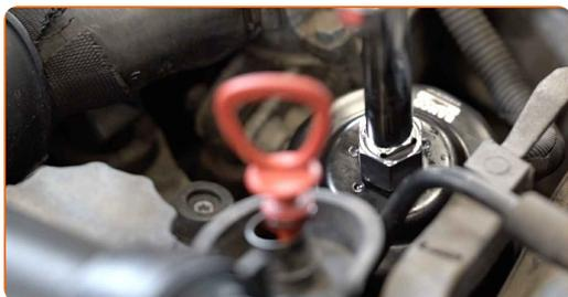
**26** Odstranite krpo iz mikrovlaknen iz ohišja oljnega filtra.
