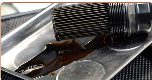
**8** Pokrijte ohišje oljnega filtra s krpo iz mikrovlaken, da preprečite vnos umazanije in tujih delcev.
