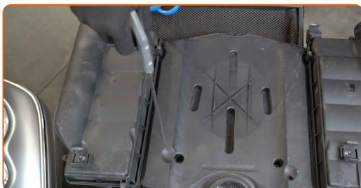
**9** Odvijte pritrdilne elemente pokrovov zračnega filtra. Uporabite vijaki nastavek T20. Uporabite izvijač z zatikalom.
