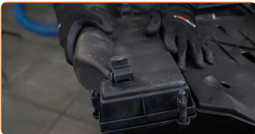
**15** Privijte pritrdilne elemente pokrovov zračnega filtra. Uporabite vijačni nastavek T20. Uporabite izvijač z zatikalom.
