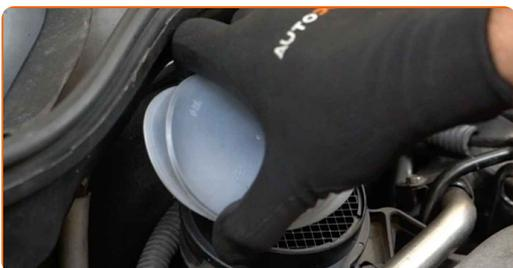
**17** Ponovno namestite ohišje zračnega filtra.
