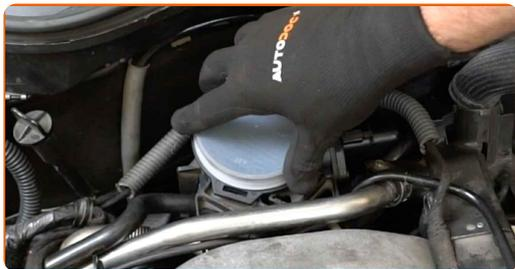
**8** Očistite pokrov zračnega filtra in ohišje.
