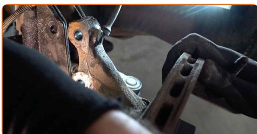
**18** Odvijte pritrdilne elemente na vrhu nosilca amortizerja. Uporabite nasadni ključ №19. Uporabite izvijač z zatikalom.
