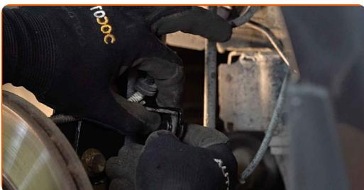
**52** Zategnite nosilec zavorne cevi na opornik. Uporabite nasadni ključ №10. Uporabite izvijač z zatikalom.
