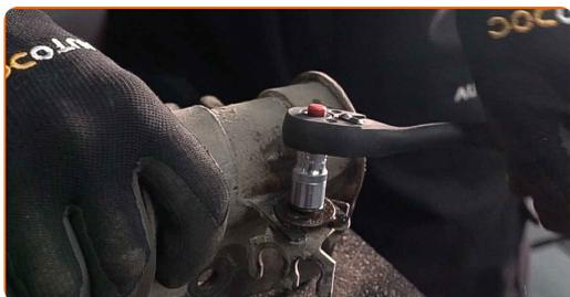
**50** Odstranite nosilec z opornika amortizerja.
