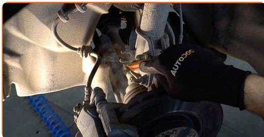
**13** Odvijte matico in odstranite drog stabilizatorja z opornika. Uporabite kombinirani ključ №17. Uporabite izvijač z zatikalom.
