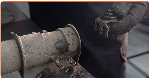
**51** Namestite nosilec na opornik amortizerja.
