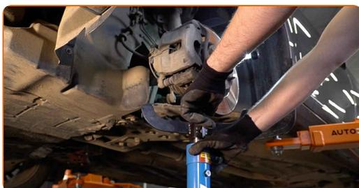
**15** Odvijte spodnji pritrdilni element, ki povezuje blažilnik s premnikom. Uporabite kombinirani ključ №15. Uporabite nasadni ključ №17. Uporabite udarni nasadni ključ.
