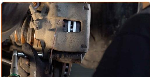
**19** Priključite vtič senzorja za obrabo zavornih oblog.
