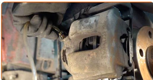
21 Večkrat pritisnite na zavorni pedal, da odstranite zrak iz sistema.
