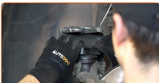
**28** Namestite zavorno čeljust in jo privijte. Uporabite imbus št. H7. Uporabite navorni ključ. Zategnite ga do navora 30 Nm.
