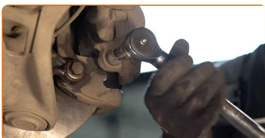
**29** Namestite pokrovčke manšete vodilnih zatičev zavornih čeljusti.
