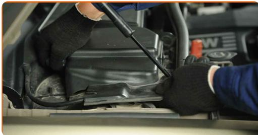
**4** Odstranite zaščitno masko vetrobranskega stekla nameščeno na levi strani. Uporabite ploščat izvijač.
