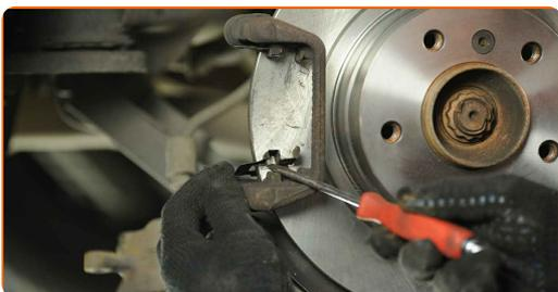
**13** Očistite umazanijo in prah iz nosilca zavorne čeljusti. Uporabite žično krtačo. Uporabite čistilo zavor.
