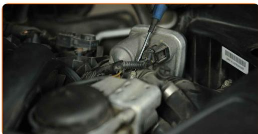
9 Odstranite ohišje zračnega filtra.
