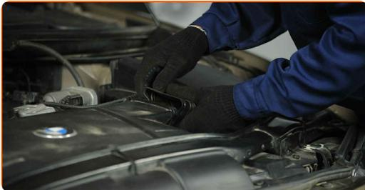
**4** Izključite konektor senzorja za masovni pretok zraka. Uporabite ploščat izvijač.
