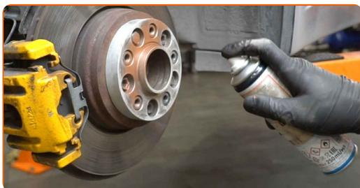
**29** Očistite površino zavornih kolutov. Uporabite čistilo zavor.
