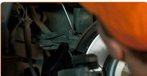
**8** Odstranite nosilec ožičenja ABS senzorja z zgornje ročice. Uporabite ploščat izvijač.
