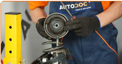
**33** Zategnite matico amortizerja. Uporabite kombinirani ključ №18. Uporabite imbus št. H7. Uporabite navorni ključ. Zategnjite ga do navora 27 Nm.
