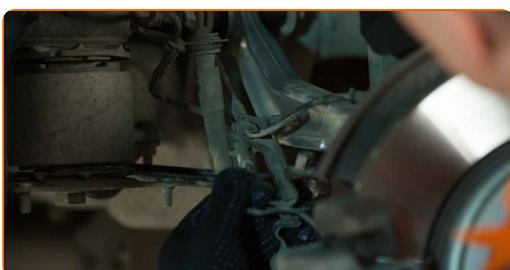
**8** Očistite vse sklepe prečnega vodila. Uporabite žično krtačo. Uporabite sprej WD-40.
