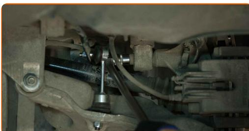
**16** Odstranite pritrdilni vijak. Uporabite kombinirani ključ №18. Uporabite ploščat izvijač.
