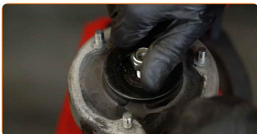
**44** Zategnite matico amortizerja. Uporabite imbus št. H6. Uporabite nasadni ključ №18. Uporabite navorni ključ. Zategnite ga do navora 27 Nm.
