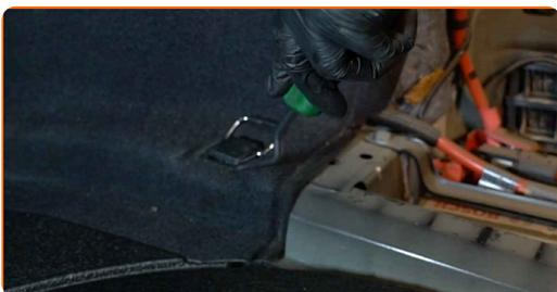
**6** Odvijte pritrdilne elemente sprednje obloge prtljažnika. Uporabite vijačni nastavek T40. Uporabite izvijač z zatikalom.
