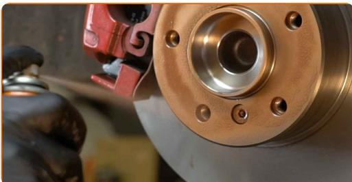
**36** Očistite površino zavornih kolutov. Uporabite čistilo zavor.
