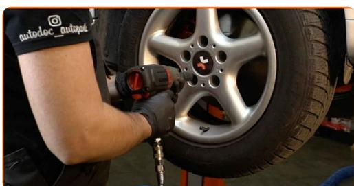
**39** Spustite avto in z delanjem v navzkrižnem vrstnem redu, zategnite kolesne vijake. Uporabite kolesni nasadni nastavek št. 17 Uporabite navorni ključ. Zategnite ga do navora 120 Nm.
