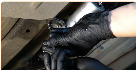
16 Zategnite pritrdilno objemko cevi filtra za gorivo. Uporabite ploščat izvijač.
