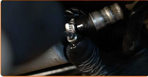
17 Očistite namestitveni nosilec filtra za gorivo. Uporabite večnamenski čistilni sprej.
