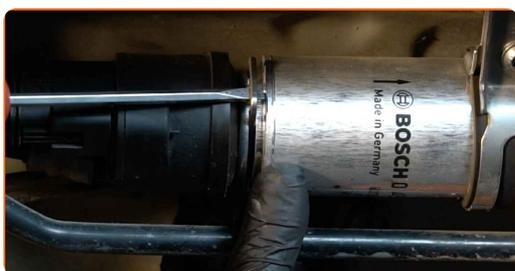
**4** Sprostite pritrdilno objemko na cev filtra za gorivo. Uporabite ploščat izvijač.
