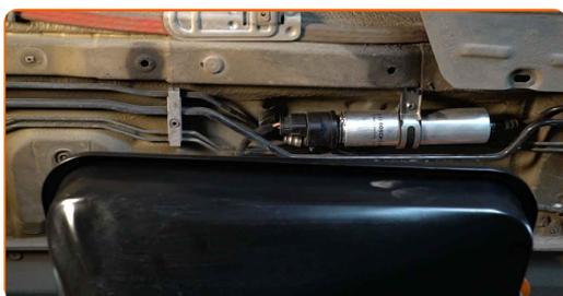
**3** Odstranite obroček pritrdilne sponke regulatorja tlaka goriva. Uporabite ploščat izvijač.
