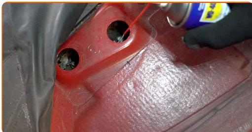
**4** Sprostite zgornje pritrdilne elemente blažilnikov. Uporabite nasadni ključ №13. Uporabite izvijač z zatikalom.
