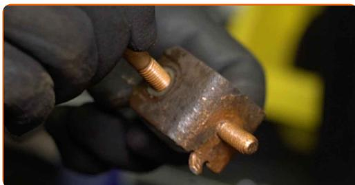
**20** Privijte pritrdilni element nosilca opornika stabilizatorja. Uporabite nasadni ključ N°13. Uporabite izvijač z zatikalom.
