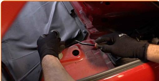
**3** Očistite pritrdilne elemente zgornjega nosilca amortizerja. Uporabite sprej WD-40.
