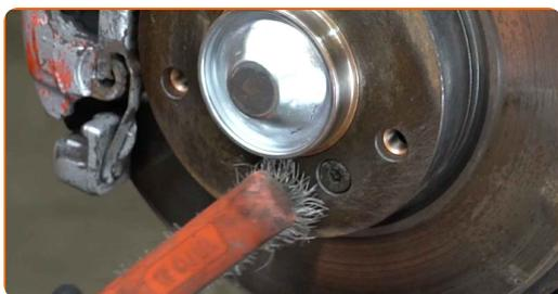
**31** Obdelajte površino, kjer se zavorni kolut stika s platiščem. Uporabite bakreno mast.
