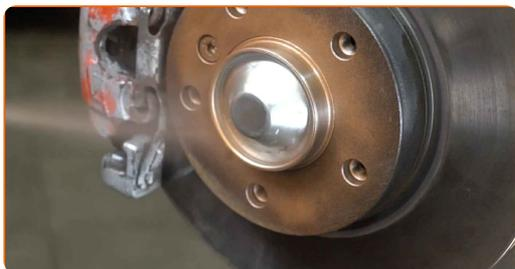
**32** Očistite površino zavornih kolutov. Uporabite čistilo zavor.
