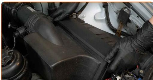
**4** Odstranite ohišje zračnega filtra.
