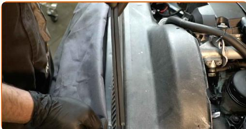
**5** Odvijte in odstranite viskozno sklopko z ventilatorjem.
