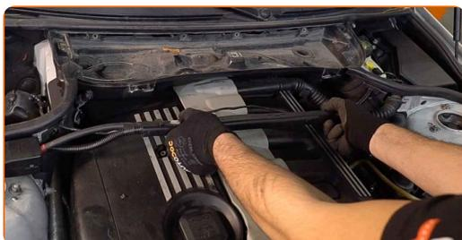
9 Odstranite ohišje zračnega filtra kabine.
