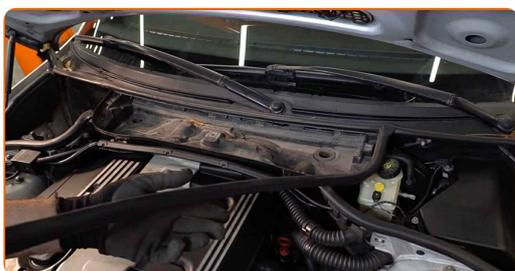
7 Odvijte pritrdilne vijake ohišja filtra. Uporabite vijačni nastavek T20. Uporabite izvijač z zatikalom.
