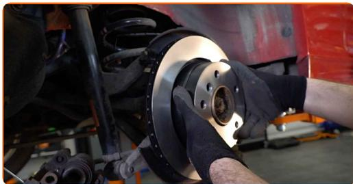
**23** Zategnite pritrditve zavornega diska. Uporabite vijačni nastavek T30. Uporabite navorni ključ. Zategnite ga do navora 16 Nm.
