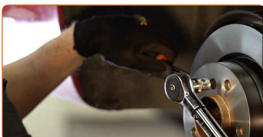
**24** Očistite umazanijo in prah iz nosilca zavorne čeljusti. Uporabite žično krtačo. Uporabite čistilo zavor.
