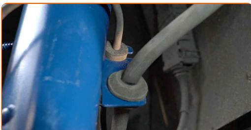
**48** Obdelajte pritrdilne elemente blažilnika. Uporabite bakreno mast.
