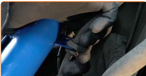
**47** Priključite napeljavo ABS senzorja.
