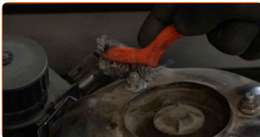
**5** Sprostite zgornje pritrdilne elemente vzmetne noge. Uporabite nasadni ključ №13. Uporabite izvijač z zatikalom.
