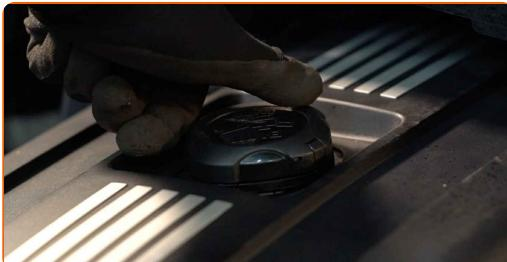
**4** Odvijte ohišje pokrova filtra skupaj s starim elementom filtra. Uporabite natični ključ 86-16F. Uporabite izvijač z zatikalom.
