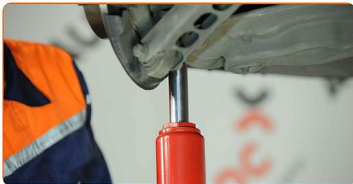
**22** Zategnite pritrdilni element kontrolne ročice na premnik. Uporabite nasadni ključ №18. Uporabite udarni nasadni ključ. Uporabite navorni ključ. Zategnite ga do navora 100 Nm.
