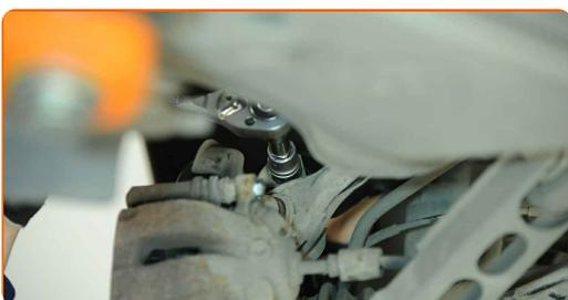
**21** Podprite premnik. Uporabite dvigalko s hidravličnim prenosom.
