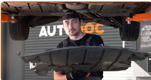
**24** Zategnite pritrdilne elemente na spodnjem pokrovu oljnega korita. Uporabite nasadni ključ №8. Uporabite izvijač z zatikalom.
