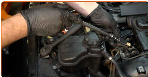
**21** Vstavite nove svečke in jih pričvrstite. Uporabite nastavek ključa za vžigalne svečke št. 16. Uporabite navorni ključ. Zategnite ga do navora 27 Nm.
