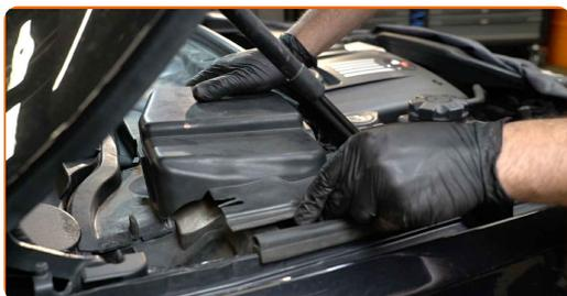
**34** Pritrdite kabelsko cev na zgornji del ohišja mikrofiltra.
