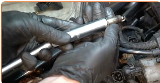
**19** Nanesite tanek sloj posebnega visokotemperaturnega maziva proti zatikanju na navoje novih vžigalnih svečk.
